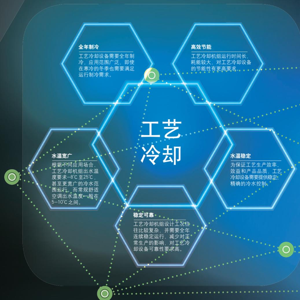
工艺冷却是对正在使用的生产设备、机器或产品本身进行的一种冷却，旨在提高生产效率、提升产品品质、改善外在环境的工艺过程。不同于传统的舒适性空调，工艺冷却空调的服务对象是设备或者物品，涉及到化工、制药、食品、酿酒、煤炭、机械设备、特殊工艺冷却等工业领域的制冷需求。
